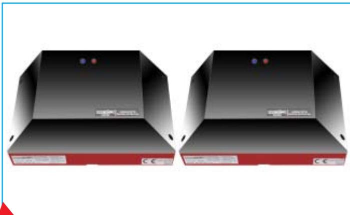
I rivelatori RK100B e RK200B sono rivelatori ottici lineari di fumo di tipo a barriera Trasmettitore (TX) e ricevitore (RX) separati. Il rivelatore RK100B è dotato di portata ottica massima di 120m. Il rivelatore RK200B è dotato di portata ottica massima di 200m.
