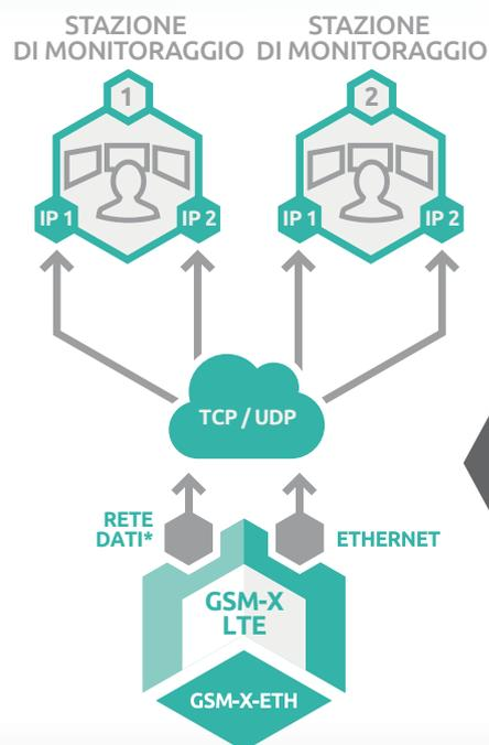
Dual Path Reporting implementato con GSM-X LTE + GSM-X-ETH
