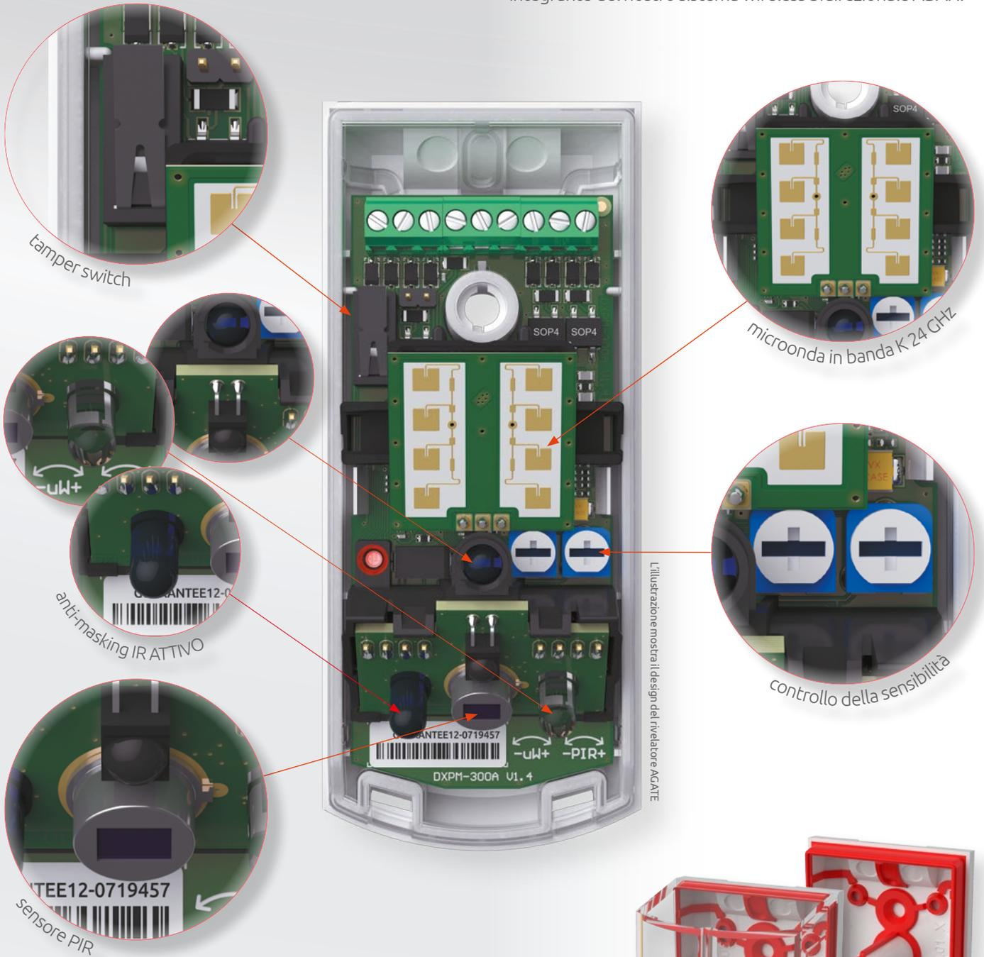
La custodia degli rilevatori sono costituiti da una combinazione di policarbonato ed elastomero termoplastico con tecnologia ad iniezione bicomponente. Il grado di protezione ottenuto è IP54, che li rende adatti per applicazioni all'aperto.
