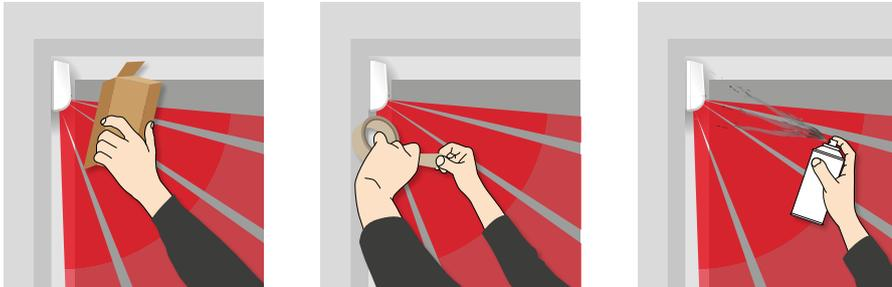
Secondo la norma EN 50131-2-4, la funzione di anti-mascheramento attivo di **AGATE** è implementata nel circuito del rivelatore ad infrarossi, che fornisce una protezione avanzata contro:
