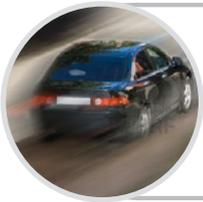
**ANTI-STRISCIAMENTO:** L'effetto "strisciamento" impedisce la lettura del carattere. Il fenomeno si presenta sia in condizioni di scarsa illuminazione che con telecamere con sensori standard (30 Fps). La soluzione è quella di utilizzare sensori ad alta velocità (60 Fps) di tipo Global Shutter.
