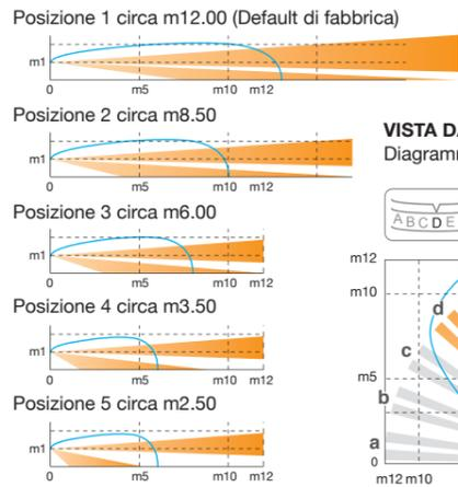
La distanza massima di rilevazione dipende dalle condizioni di temperatura in un dato ambiente.
