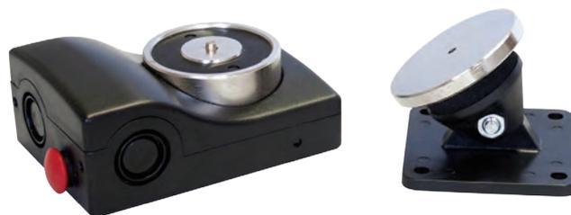
Per il collegamento sono disponibili tre ingressi laterali per tubo da 16 o 20 mm e un ingresso posteriore per cavo diametro max 10 mm. Disponibile versione con controllo dello stato porta che indica, con elettromagnete alimentato, se la porta è aperta (contatto NC) o chiusa. Controplacca fornita di serie. Con l'apposita staffa, a richiesta, è possibile l'installazione a pavimento. Certificazione CPD secondo UNI EN1155:2003.
