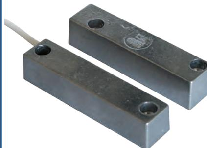
un'ampolla incapsulata ermeticamente con resina poliuretana insieme ad un loop di tamper per ridurre le possibilità di effrazione. La versione a morsetti è provvista di protezione contro lo strappo ed un circuito stampato in grado di alloggiare eventuali resistenze di bilanciamento. Predisposizione per guaina di protezione cavo in acciaio plastificato diametro 10 mm (non fornita).
